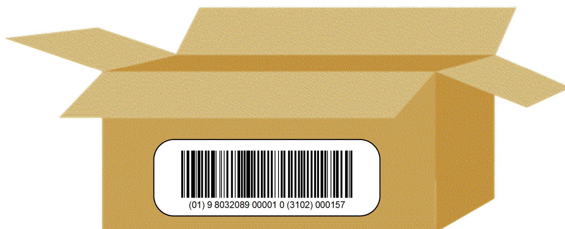
Figura 4-5: Codice a barre a peso variabile per imballo
