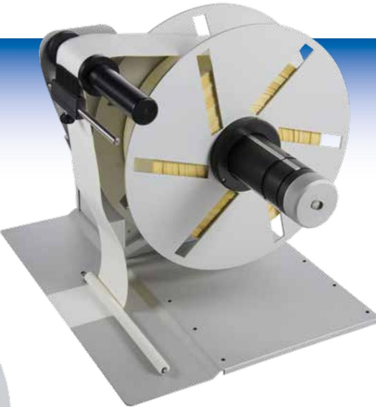
L'esigenza di sovrastampa di grandi volumi è sempre più presente e **Kodit s.r.l.** ha sviluppato una completa gamma di svolgitori e riavvolgitori per poter utilizzare bobine di diametro massimo di 400 mm. e larghezza massima di 230 mm.
